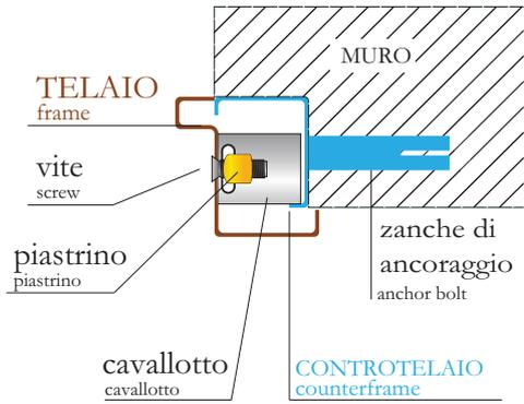
**Tipologia di montaggio a mezza mazzetta**
