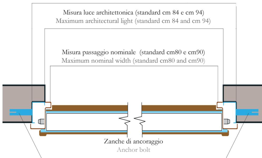
**Tipologia di montaggio a filo intonaco interno**
