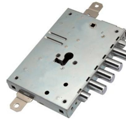
La Serratura Automatica Meccanica è più sottile (25mm), intercambiabile con le attuali serrature di spessore 30. Dispone di chiusura Automatica o Meccanica a fermo giorno, con sblocco rapido dall'interno, azionato da maniglia, disposto di cilindro di sicurezza Champions a profilo europeo che conferisce alle porte livelli di sicurezza differenziati. Con il semplice accostamento del battente della porta si attiva automaticamente il sistema ed escono i catenacci fino alla completa chiusura.
