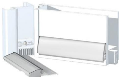
La soglia CCE è un sistema ideato per l'installazione valido anche per porte già esistenti dove sia necessario inserire una soglia drenante. La soglia va in battuta sull'anta della porta con una morbida guarnizione in silicone autoestinguente. Il sistema può essere completato con l'utilizzo del gocciolatoio, che grazie alla spazzola in polipropilene con pinna, contribuisce ad aumentare la tenuta all'acqua.
